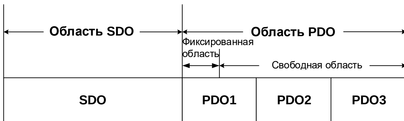
Рисунок 3-1 Структура данных информационного кадра CANopen PD310CAN
