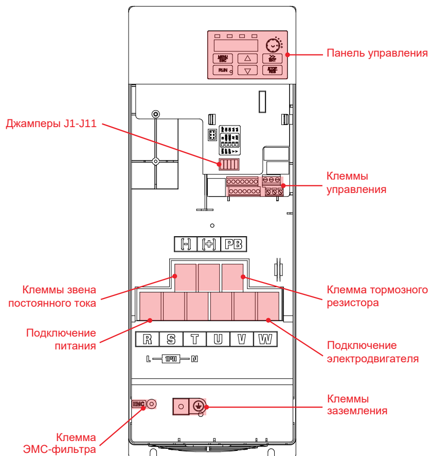
Рисунок 4-5 Расположение клемм преобразователей частоты PD210-A4150B, PD210-A4185B, PD210-A4220B
