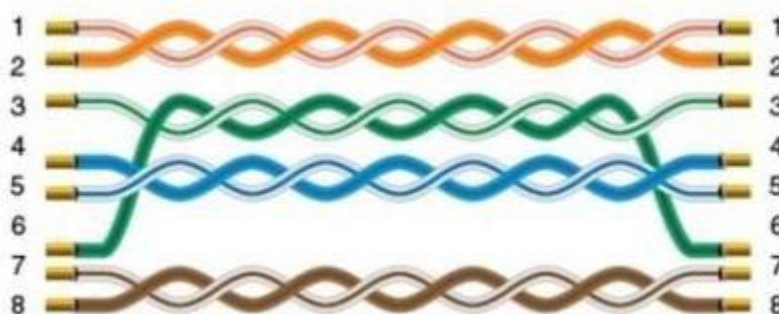
Рисунок 11-26 — Схема обжима кабеля связи.
