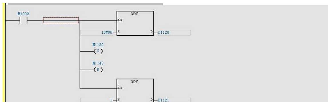
Рисунок 18–312 — Пример коммуникационной программы для ПЛК Delta DVP.
