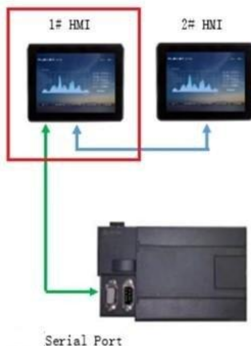
Рисунок 19–47 — Схема подключения нескольких панелей HMI к ПЛК.
