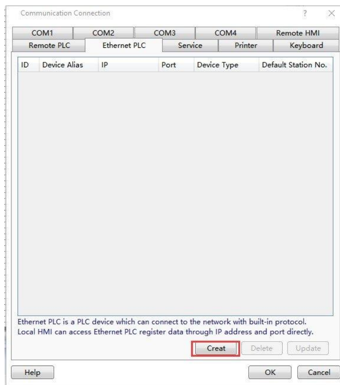
Рисунок 18–236 — Диалоговое окно Communication Connection с выбранной вкладкой Ethernet PLC и кнопкой Create.
