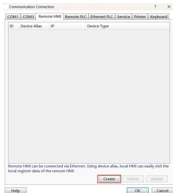
Рисунок 15–3 — Диалоговое окно настройки удаленного HMI с кнопкой «Создать».
