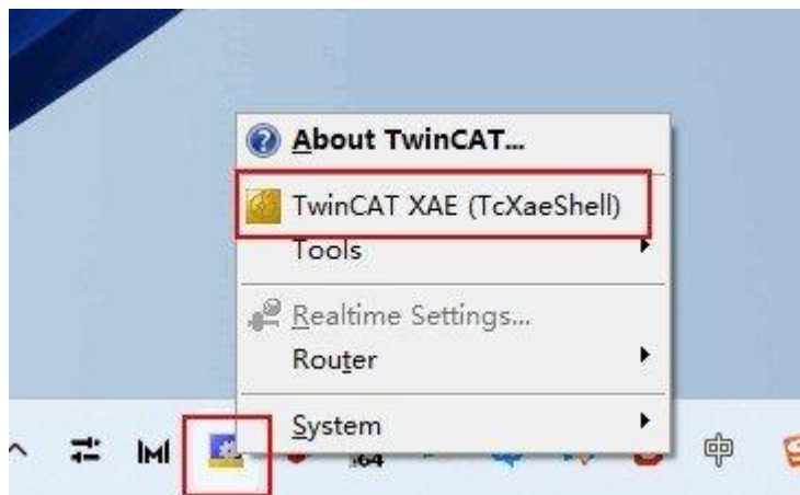
Рисунок 18–58 — Выбор TwinCAT XAE из контекстного меню значка TwinCAT.
