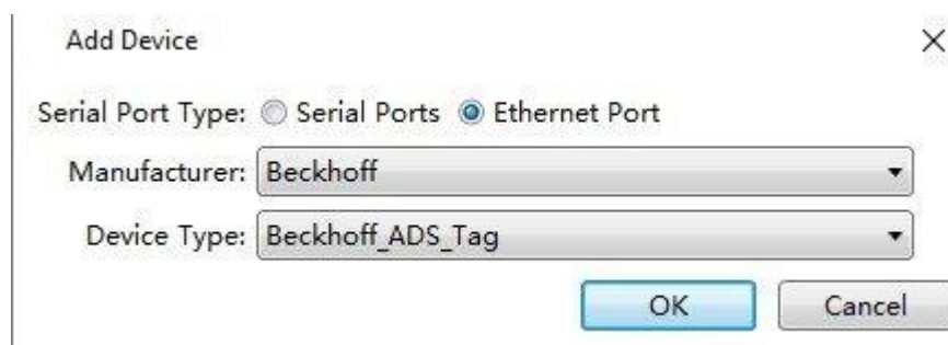
Рисунок 18–97 — Настройка параметров нового устройства в диалоговом окне Add Device.
