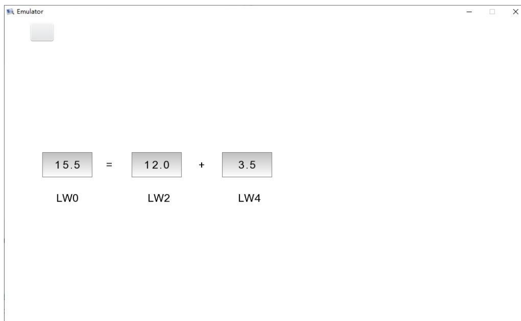
Рисунок 19–45 — Интерфейс эмулятора HMI, демонстрирующий сложение двух числовых значений.
