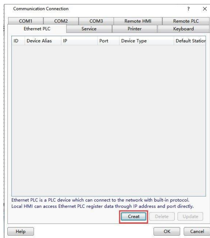
Рисунок 18–296 — Диалоговое окно Соединение для связи с выбранной вкладкой Ethernet PLC и кнопкой Создать.
