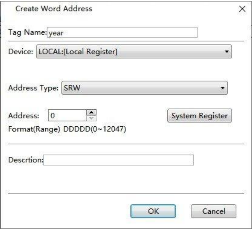
Рисунок 11–4 — Диалоговое окно создания нового адресного тега.
