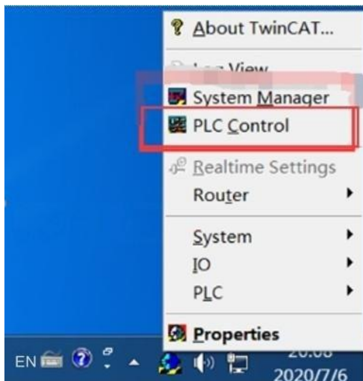
Рисунок 18–153 — Выбор пункта PLC Control в контекстном меню TwinCAT.
