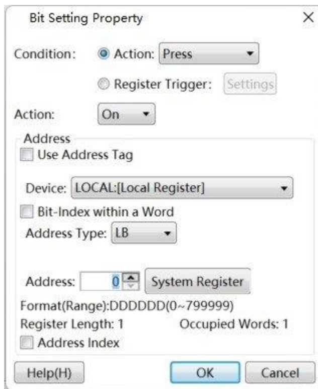
Рисунок 10–2 — Диалоговое окно настройки свойств установки бита.
