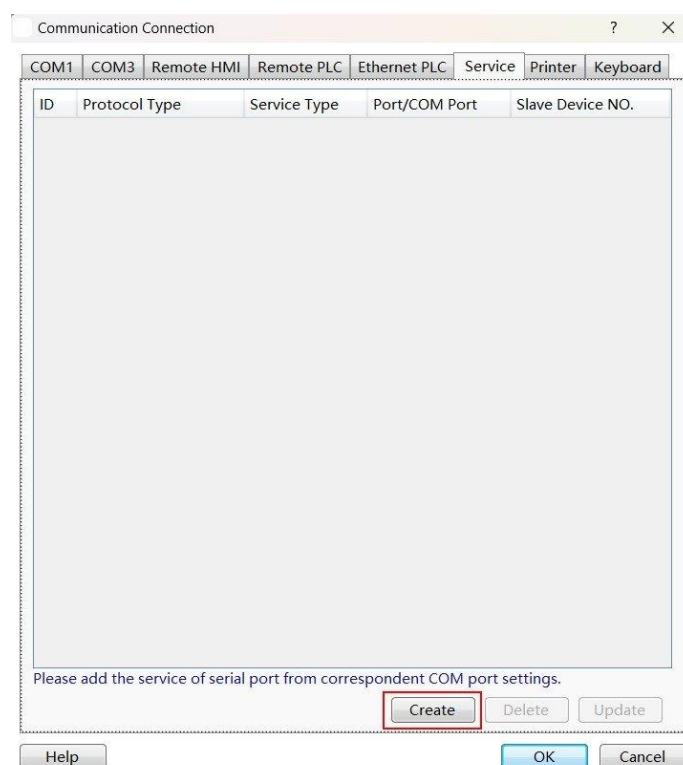
Рисунок 15–12 — Диалоговое окно «Communication Connection» с выбранной вкладкой «Service» и кнопкой «Create».
