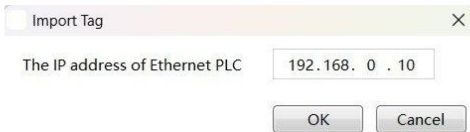
Рисунок 18–426 — Окно ввода IP-адреса ПЛК для онлайн-импорта тегов.
