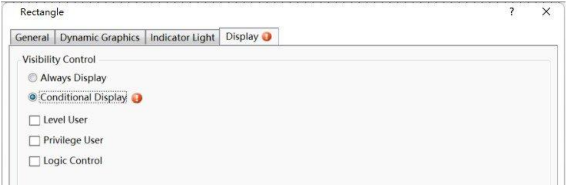
Рисунок 9–11 — Настройка свойств отображения для элемента "Прямоугольник".
