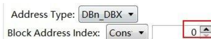
Рисунок 18–400 — Настройка индекса адреса блока данных в HMI.
